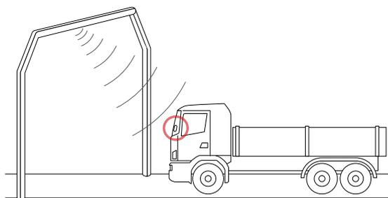
На тех участках дорог, где используется радиосистема, местонахождение определяется с помощью антенн, установленных вдоль выделенных полос, или же, там где доступна услуга *free-flow*, на рамках контроля, установленных вдоль дорожной сети. В момент проезда под рамками контроля правильное срабатывание устройства подтверждается соответствующим звуковым сигналом и/или сообщениями на дисплее.
