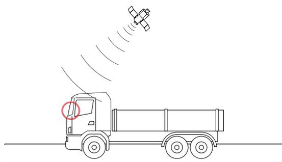
На тех участках дорог, где используется спутниковое обслуживание, проезд транспортного средства по платным дорогам регистрирует система GNSS.
